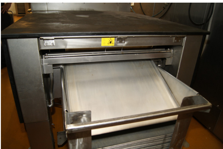
Links: Auch die widerstandsfähigsten Bürsten müssen einmal ausgetauscht werden, wenn sie im Dauereinsatz sind. Dank „Quick Lock“ ist das kein Problem. Rechts: Sind in der Anlage gereinigten Bleche fallen sauber zum Abtransport in einen bereitgestellten Blechwagen.
